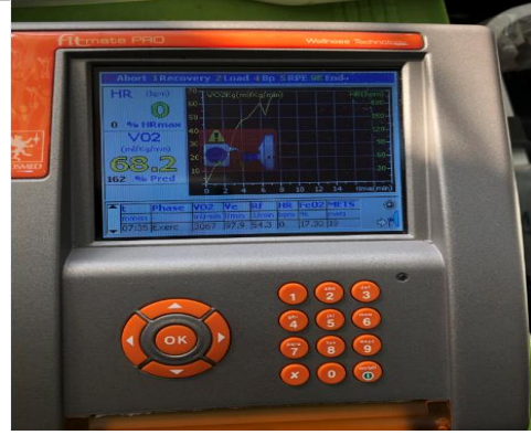
جهاز فت مت برو ( Fit mate Pro ) لقياس الحد الأقصى لاستهلاك الأوكسجين vo2max .
