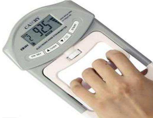
شكل (3) يوضح صورة جهاز قياس قوة القبضة
